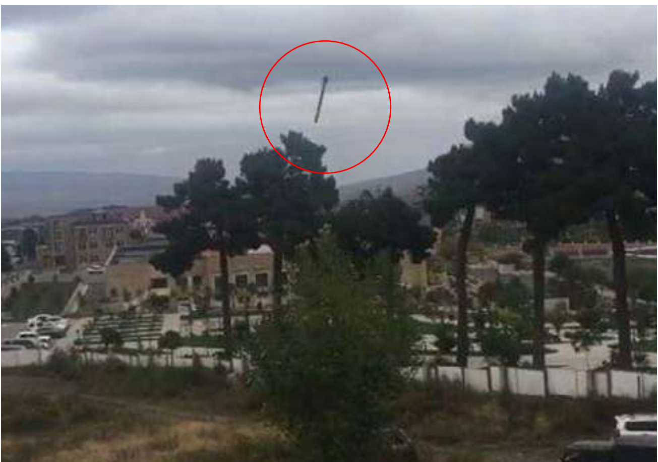
Պատկեր 15.58. 9M5 տիպի «Երկիր-երկիր» 300մմ արկի հատված: Նշենք, որ առջևի հատվածում բացակայում է աերոդինամիկական ձև ունեցող մարտագլխիկը, ինչը վկայում է առանձնացող մարտագլխիկի տարբերակ կիրառելու մասին, 4 հոկտեմբերի, 2020թ. (Աղբյուրը՝ «Kotnews»-ի տելեգրամյան ալիք):
