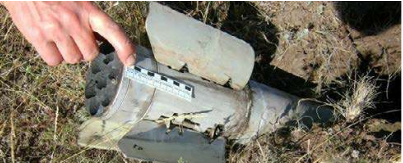
Պատկեր 15.32. 122 մմ հրթիռի պոչի հատվածը՝ բացված պոչաթևերով, ձգման համակարգով և ծայրափողակով, 2012թ. (Աղբյուրը՝ «Администрация Соль-Илецкого городского округа»):
