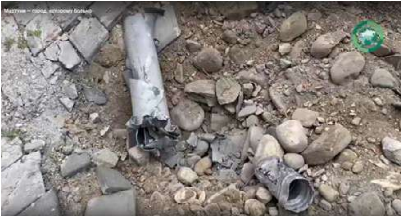
Պատկեր 15.30. Արկի վնասված հատվածը Մարտունու քաղաքապետարանի տարածքում, որտեղ երևում են հրթիռի հիմնական իրանի մի մասը և դրա պոչային մասի հատվածը՝ կայունացնող պոչաթևերի զսպանակի պատյանով, 1 հոկտեմբերի, 2020թ. (Աղբյուրը՝ «Федеральное агентство новостей»):
